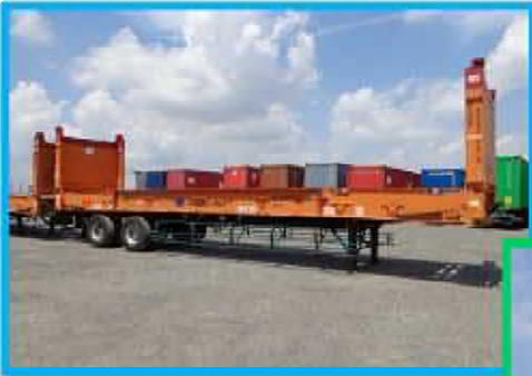
40フィートのフラットコンテナを低床シャーシでは PICK できないので、コンテナ専用シャーシで PICK します。
